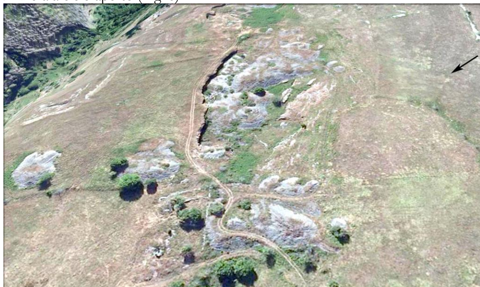
Fig. 6 - Distretto di Acquafredda (Roccamorice), settore nord-est. L'ortofoto, visualizzata in 3D, mostra uno dei fronti di cava, il piazzale antistante, cumuli di rocce frantumate e materiali di scarto
